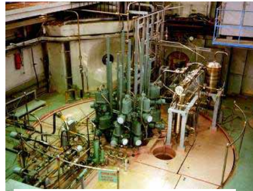
カザフスタンIGR試験炉 ナトリウムが排除された空間を溶融燃料が通過
